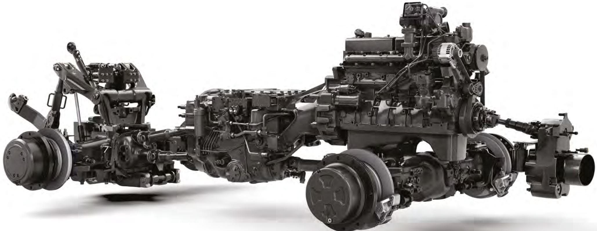
**Bezstupňová převodovka zajišťuje optimální využití výkonu a točivého momentu s plynulým zrychlením a přenosem výkonu, ideální rychlostí pro každou situaci a velmi jemným řízením rychlosti. Navíc umožnuje vysoce kvalitní práci se všemi druhy pracovních nástrojů.**
