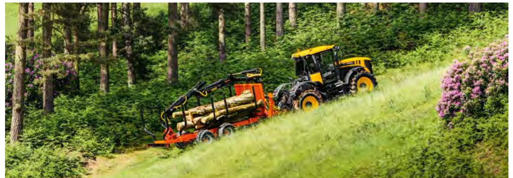
Řízení všech čtyř kol zmenšuje poloměr otáčení pod 10 metrů (v závislosti na pneumatikách). Třípolohový přepínač umožňuje obsluze rychle přepínat mezi režimem řízení dvou kol (2WS), čtyř kol (4WS) a plně uživatelsky programovatelným režimem.
