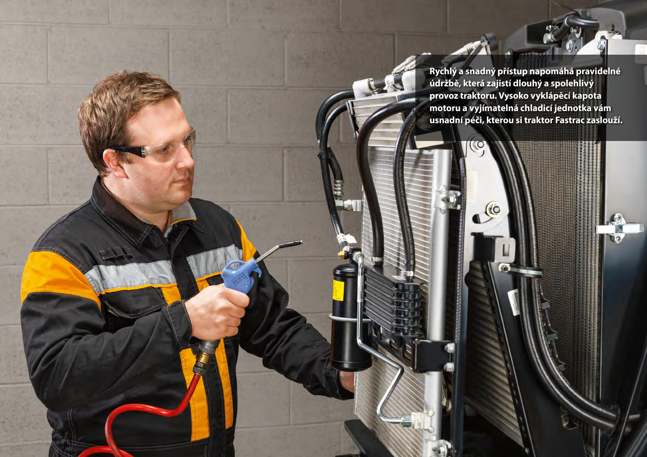
Rychlý a snadný přístup napomáhá pravidelné údržbě, která zajistí dlouhý a spolehlivý provoz traktoru. Vysoko vyklápěcí kapota motoru a vyjímatelná chladicí jednotka vám usnadní péči, kterou si traktor Fastrac zaslouží.
