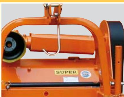
Trasmissione laterale a cardano (TBM/S)
